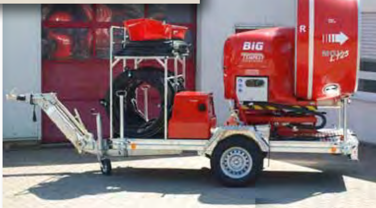
Anhänger: mittlere Ausführung mit Regal für Spiralschlauch- system
